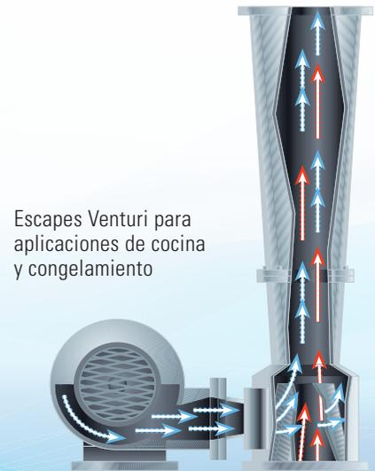
Sistema de filtración de escape con diseño de separación de partículas
